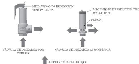
La tubería de entrada debe tener un diámetro mayor o igual que el cilindro de entrada de la válvula de seguridad (DN) y debe ser lo más corta y recta posible.
